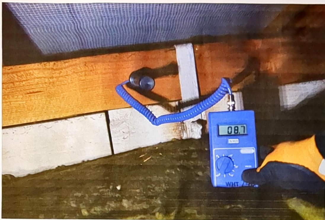
Obr.č.2: Vlhkost dřeva na pozednici měřená odporovým vlhkoměrem
